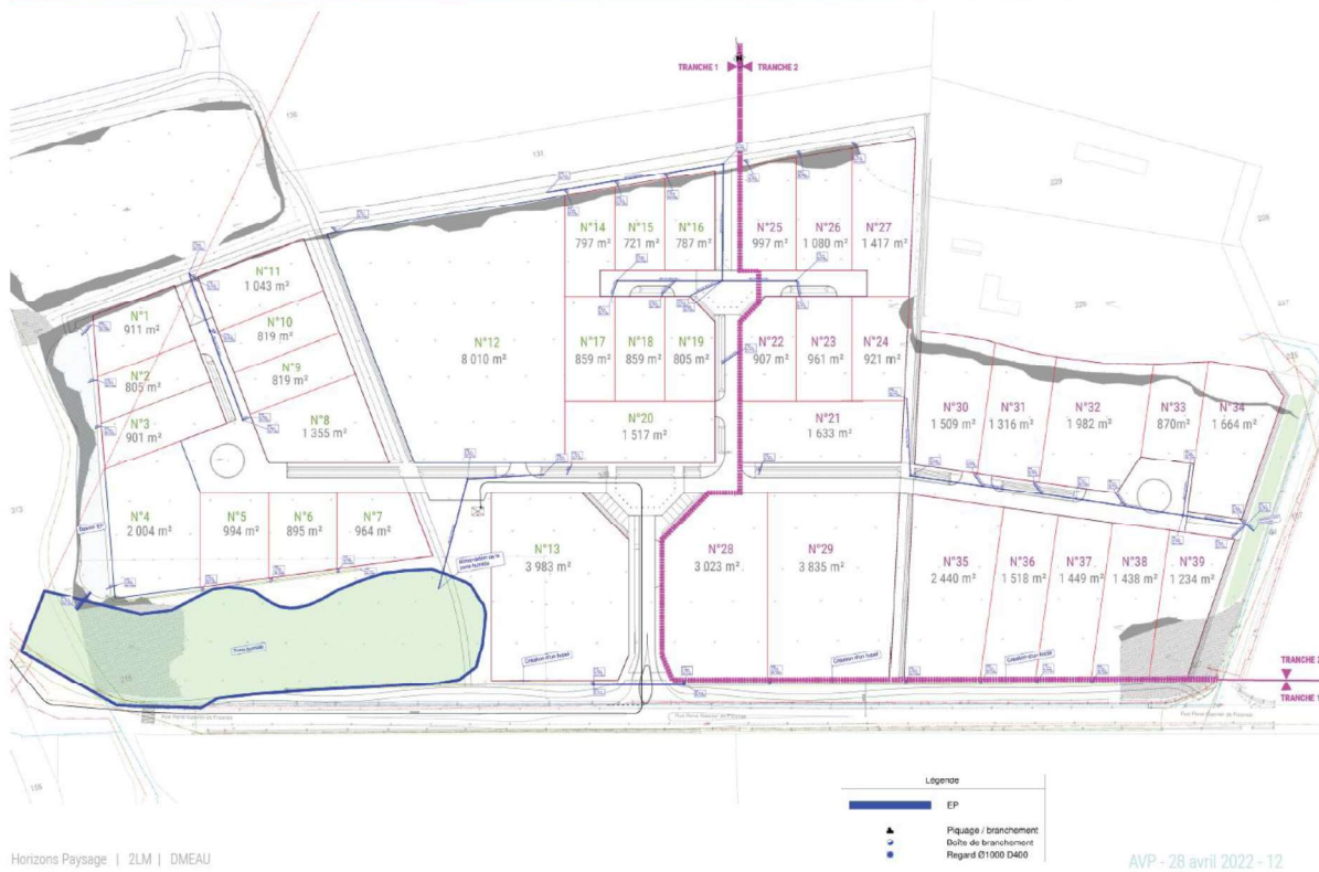
Plan de la gestion des eaux pluviales
