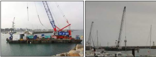
Figure 87 : Exemple de barges pour travaux maritimes – Port Haliguen à Quiberon (source : INGEROP)
