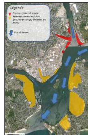
Figure 32 : Localisation des zones d'accrétions privilégiées à l'échelle de la rade de Lorient (source : Étude des systèmes de mise en suspension des sédiments, IDRA Environnement, 2013)
