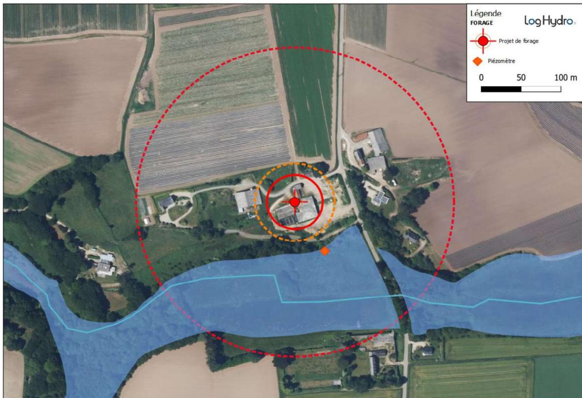
Un piézomètre court (2 m) réalisé à la tarière à main sera implanté dans la zone humide la plus proche au Sud du forage. Un suivi de la piézométrie se fera pendant l'essai par paliers et pendant l'essai longue durée (12 h au minimum), ce qui permettra d'estimer l'incidence éventuelle du pompage sur le milieu.
