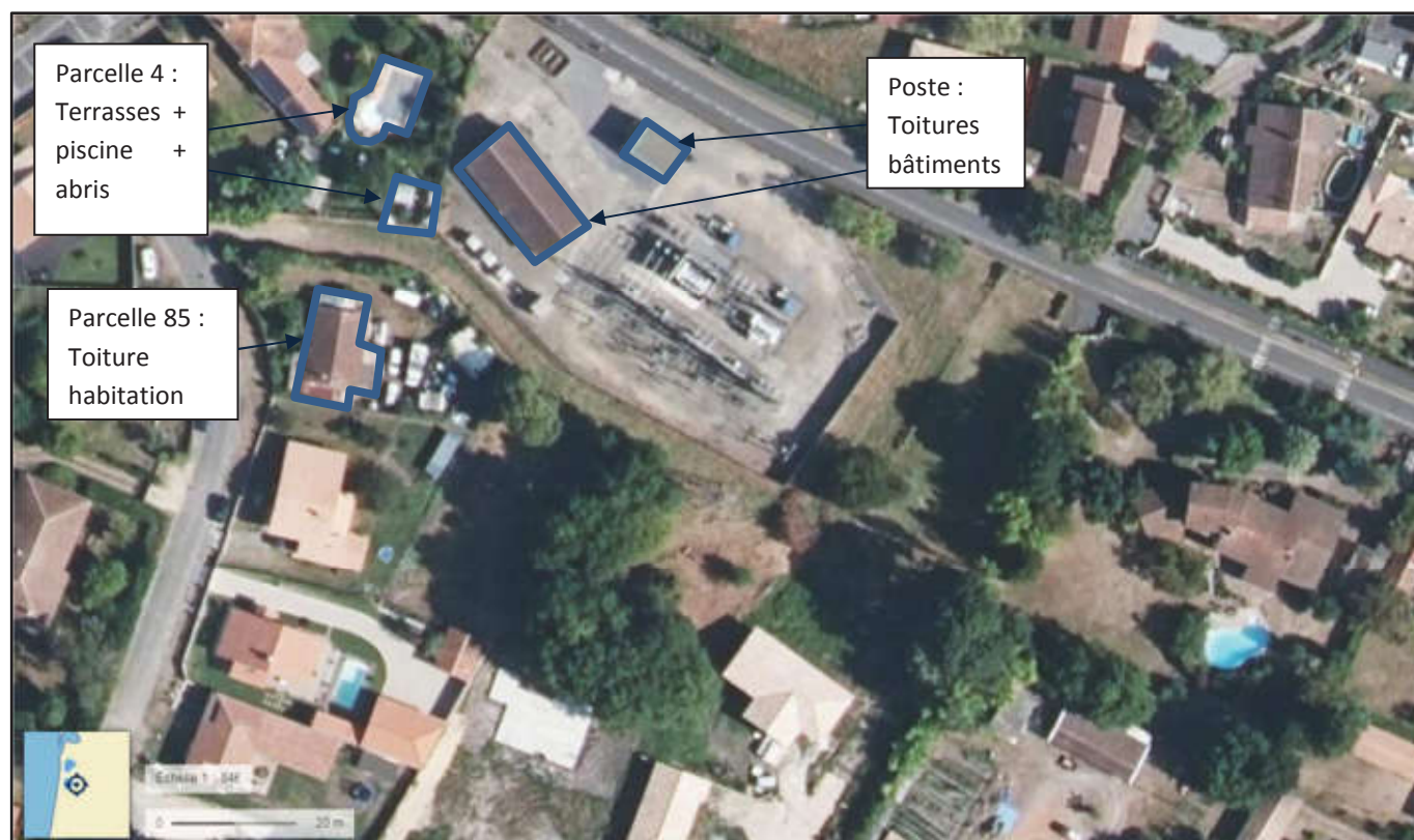
Figure 19 : Emplacement des surfaces prises en compte pour le dimensionnement de l'ouvrage de gestion EP (ECR Environnement)
