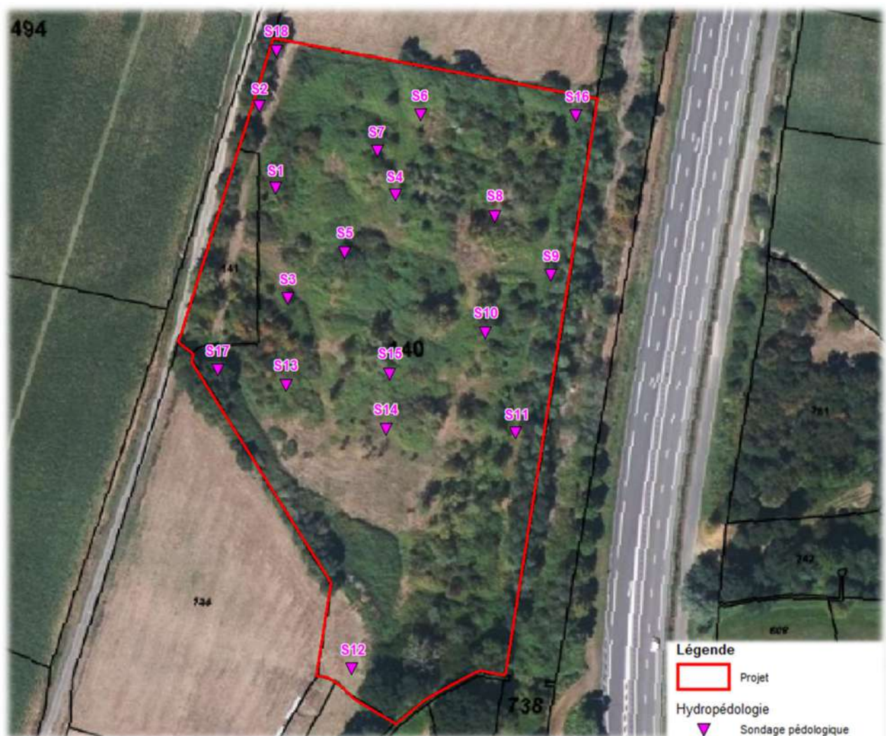
Figure 4 : Implantation des sondages de sol et des tests de perméabilité
